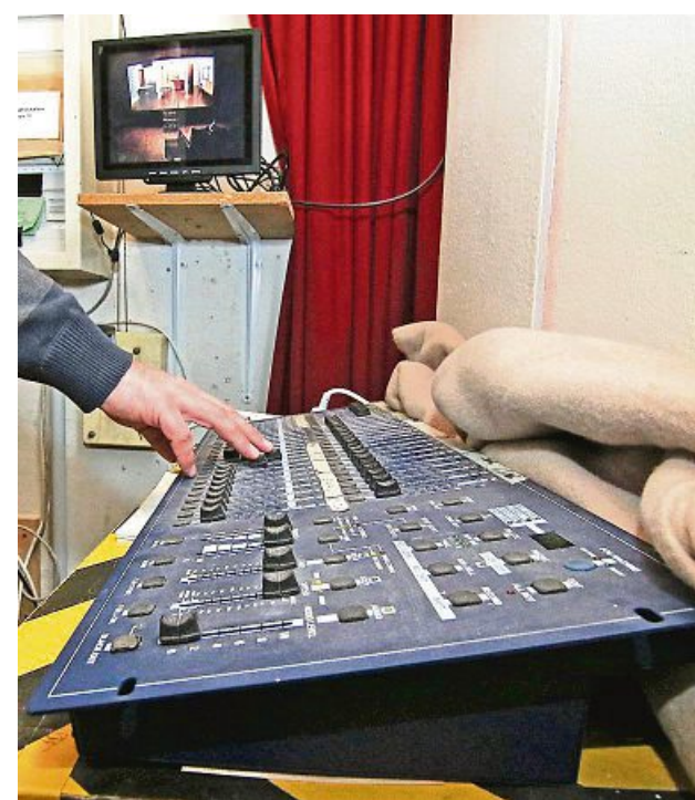
Die Technik: Am Monitor sehen die Darsteller, wann ihr Einsatz kommt. Davor befindet sich das Mischpult.
